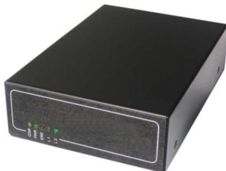
I messaggi SMS in arrivo dai dispositivi PHS, tramite il modem GSM interno al sistema di gestione SMS/HTTP PUSH e alla SIM card in esso contenuta, vengono estratti dal microprocessore ed elaborati singolarmente (testo, numero del mittente e data-ora di trasmissione del messaggio ricevuto, coordinate) e trasmessi su Rete Ethernet con una semplice transazione HTTP verso un qualunque script Web (.asp, .php, .pl, .cgi, .jsp, ecc..) in modalità POST.
