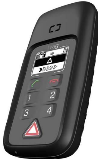
**PHS80 - twig protector** è un dispositivo di chiamata di emergenza MANUALE tramite rete GSM e con localizzazione GPS **compatto**, fornito sia in versione **IP67**, che permette 4 chiamate voce con funzione vivavoce sia premendo il pulsante di allarme che automaticamente grazie al  **sensore di rilevazione di mancanza di movimento**, l'invio 3 SMS con indicazione della localizzazione. Fornito preconfigurato, segnala la propria accensione / spegnimento tramite sms automatico.
